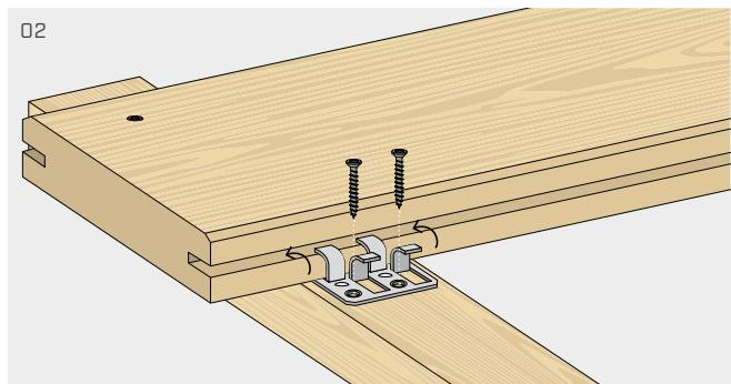
Inserire nella scanalatura il connettore GAP4 in modo che i denti centrali della clip siano aderenti alla fresatura della tavola.
