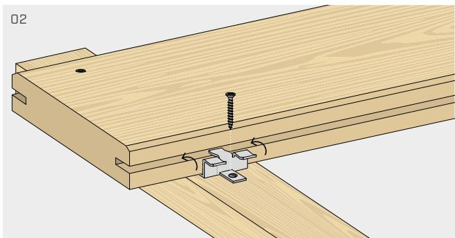
Inserire nella scanalatura il connettore GAP3 in modo che il dente centrale della clip sia aderente alla fresatura della tavola.
