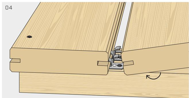
Posizionare la tavola successiva infilandola nel connettore GAP4 in modo che i due denti aderiscano alla fresatura della tavola.
