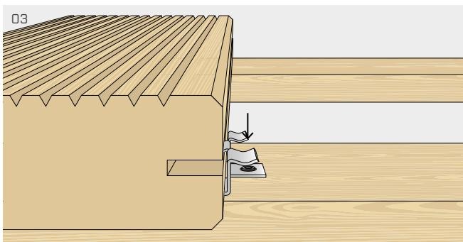
Fissare la vite nel foro centrale.
