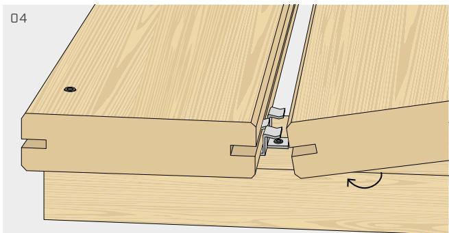
Posizionare la tavola successiva infilandola nel connettore GAP3 in modo che i due denti aderiscano alla fresatura della tavola.
