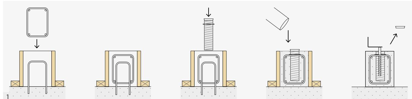
Después de preparar el encofrado para el vertido y colocar las barras de refuerzo, hay que introducir los tubos (CD60180) prestando atención en fijarlos adecuadamente a los soportes o a los encofrados para mantenerlos en su posición durante el vertido del hormigón. La alineación del centro del sistema está facilitada por las marcas en los bordes de la placa.
