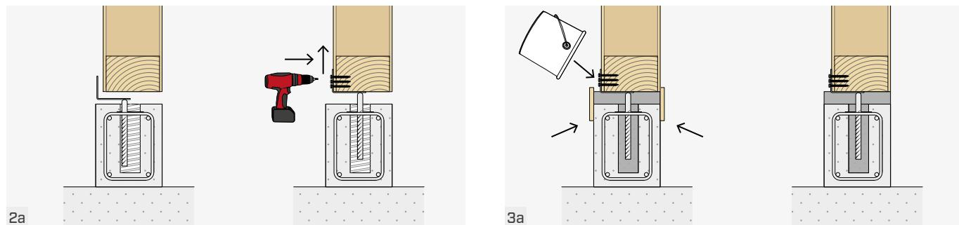
Colocación de la pared utilizando los elementos distanciadores "SHIM". Luego, se fija la placa con clavos o tornillos.
