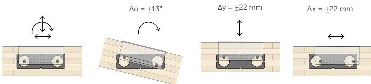
Otra ventaja respecto a las aplicaciones actuales es la posibilidad de evitar interferencias entre las armaduras en el hormigón y el sistema de anclaje. Esto agiliza considerablemente la colocación y garantiza el resultado, sobre todo en el caso de armaduras densas, y reduce el ruido y el polvo producido durante la fase de instalación.
