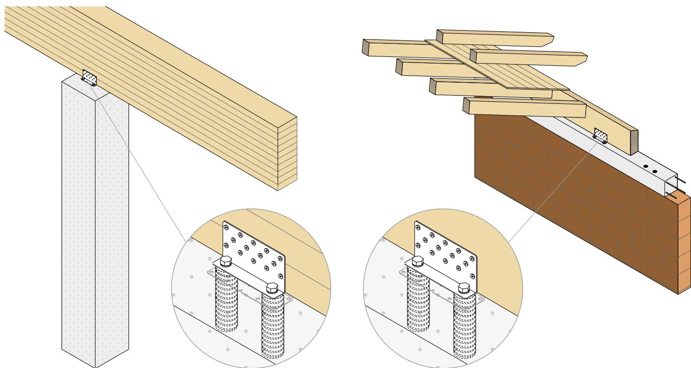
Además, el sistema de conexión TITAN DIVE ofrece interesantes ventajas en diferentes campos de aplicación. Por ejemplo, se puede utilizar para transferir fuerzas de corte entre vigas de madera y pilares de hormigón armado prefabricado o realizado en la obra. Asimismo, se puede utilizar en caso de ménsulas de hormigón armado o paredes.
