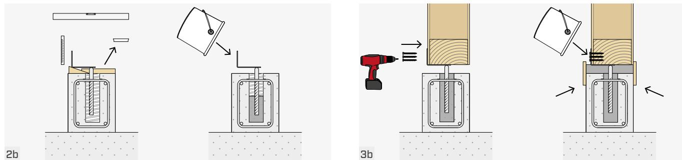
En este caso, los angulares constituyen la referencia (alineación planimétrica y altimétrica) para colocar las paredes. Después de colocar los angulares en la posición final, se realiza el vertido parcial del mortero en el interior de los tubos corrugados.
