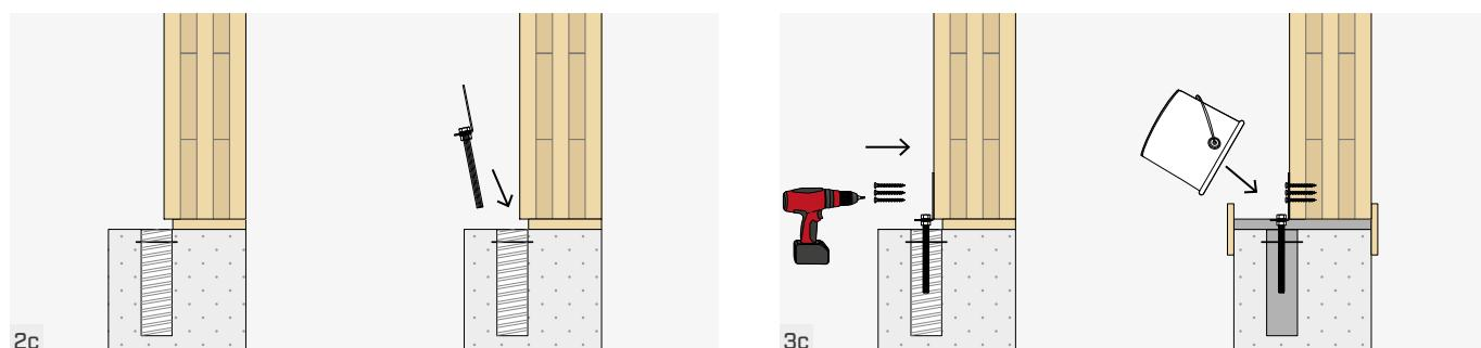
Después de instalar y nivelar la pared con distanciadores (SHIM), hay que colocar los angulares en los tubos corrugados.
