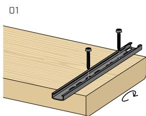
Para cada tábua, posicionar um conector e fixá-lo com dois parafusos KTX.
