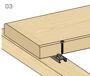
Fixar cada conector à subestrutura com um parafuso KTX em um dos dois furos sulcados.
