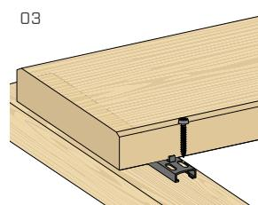
Fixar cada conector à subestrutura com um parafuso KTX em um dos dois furos sulcados.
