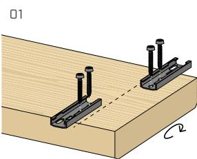
Em correspondência com cada nó de fixação, posicionar dois conectores.
