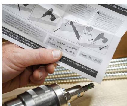
Verificare con precisione il valore limite di coppia previsto per la vite.
