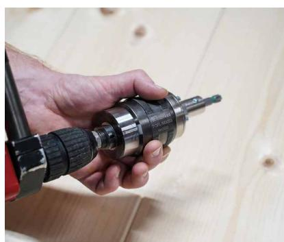
Ruotare il manicotto esterno per resettare il TORQUE LIMITER.
