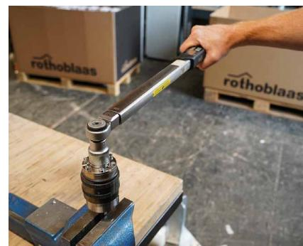
Realizar un control inicial del par con una llave dinamométrica.
