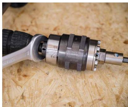
Configurar el TORQUE LIMITER en el valor de par correcto.
