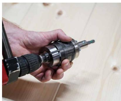
Girar el manguito exterior para restablecer el TORQUE LIMITER.
