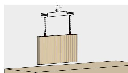
(\*) En el caso de elevación desde la posición horizontal, para los tornillos L > 300 mm la resistencia en fase de "basculación" se vuelve la resistencia predominante. En consecuencia, se deberá reducir aplicando un coeficiente de reducción de 0,8.
