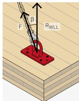
$\beta$  = ángulo de elevación (ángulo entre la vertical y la cadena)
