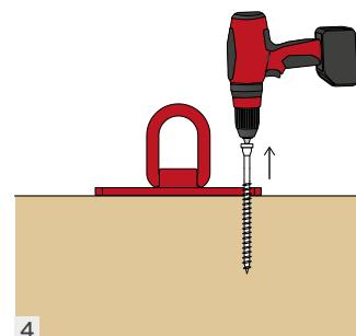
Leer con atención las instrucciones de uso y respetar las indicaciones. La placa se debe colocar en el elemento de madera a transportar respetando las distancias mínimas recomendadas.
