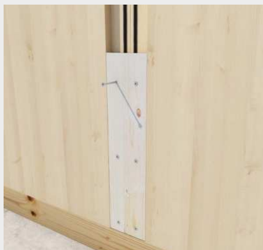
Fixation de parois en CLT avec des vis HBS de 6 mm de diamètre.
