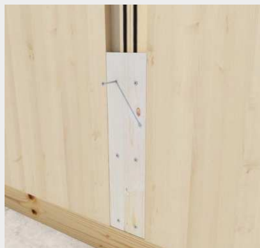
Fixação paredes em CLT com parafusos HBS diâmetro 6 mm.
