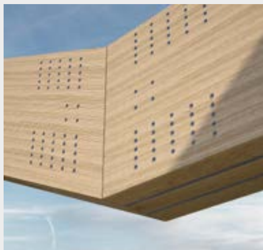
^ Kruti koljenasti spoj s dvostrukom unutarnjom metalnom pločom (LVL).
