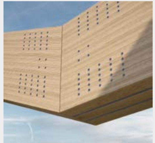
Starre knieverbinding met dubbele interne plaat (LVL).
