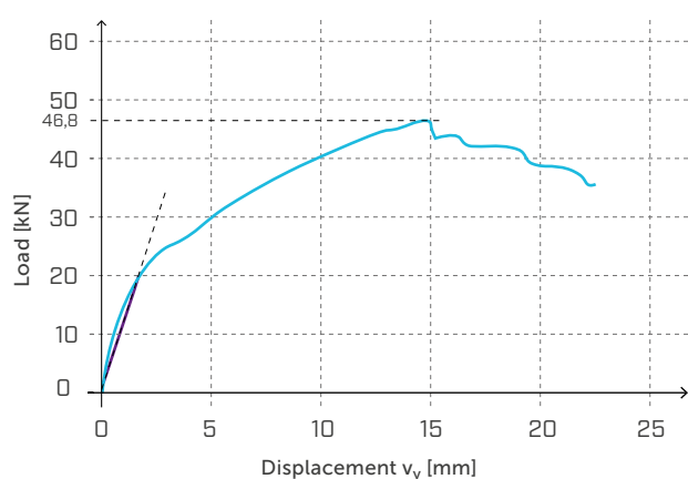
Erő-elmozdulás diagramok TCP300 mintadarabra vonatkozóan, részleges szögezés mellett (14 db. LBA \varnothing 4 \times 60 mm szög).
