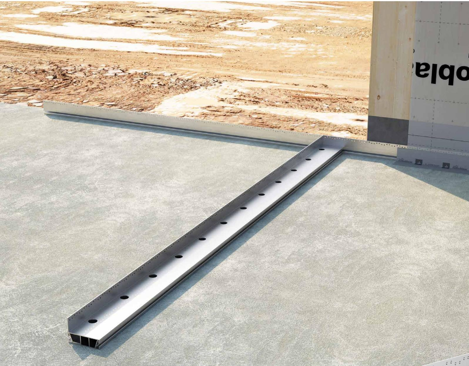
El perfil ALU START permite eliminar el contacto entre los paneles de madera y la subestructura de hormigón con lo cual se garantiza la protección contra la humedad por capilaridad y se asegura una excelente durabilidad de la fijación al suelo del edificio. Es el primer sistema de fijación al suelo que permite eliminar el hold-down y los angulares a corte. De aleación de aluminio, el sistema ALU START se puede utilizar con paredes de CLT o en sistemas de construcción timber frame.
