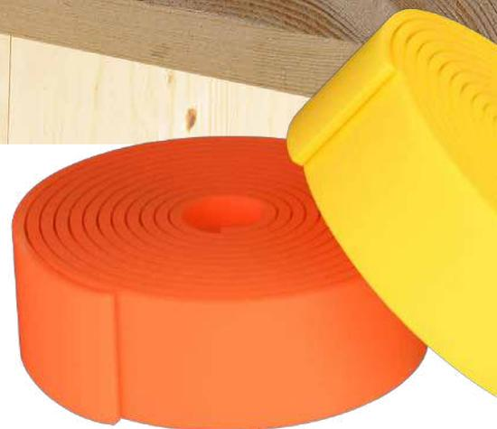
XYLOFON es el perfil resiliente de elevadas prestaciones que asegura el confort acústico en estructuras y casas de madera. Realizado en mezcla poliuretánica, está disponible en 5 versiones de 35 a 90 shore, en función de la carga que debe soportar. Probado y certificado para el uso como capa de desacople y de interrupción mecánica entre materiales de construcción, reduce la transmisión del ruido por vía aérea y estructural hasta más de 15 dB. Confía en el perfil acústico más eficaz del mercado.
