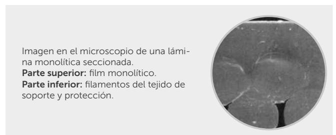
Imagen en el microscopio de una lámina monolítica seccionada.
