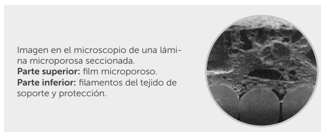
Imagen en el microscopio de una lámina microporosa seccionada.
