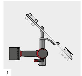
Die Stütze auf dem BENDTOOL positionieren
