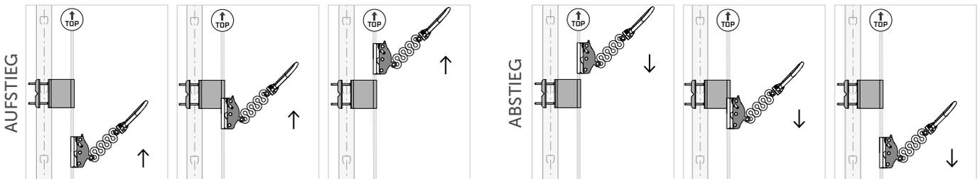
Der Gleiter VERTSLIDEPAS ermöglicht das vollständig automatische Überfahren des Zwischenelements der vertikalen Seilsicherung VERTIGRIP. Darüber hinaus hat sein vollständig aus Metall gefertigter Falldämpfer eine unbegrenzte Lebensdauer, muss jedoch jährlich überprüft werden.
