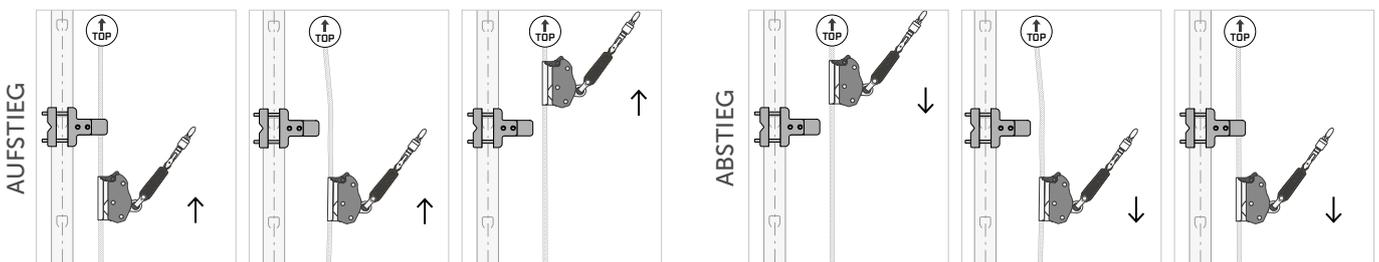
Der Gleiter VERTSLIDE ermöglicht das halbautomatische Überfahren der Zwischenhalter. Während des sicheren Auf- und Abstiegs am VERTIGRIP-System muss der Bediener das Seil aus dem VERTINT oder VERTINTW aushängen, um die Zwischenhalter zu überfahren, und es daraufhin wieder an der Endbefestigung einhängen. Dieser Vorgang lässt sich einfach und bequem ausführen.
